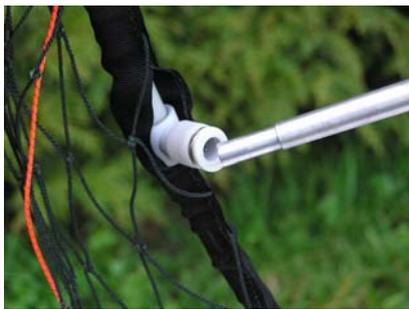
Die 4 Speichen werden in die Hülse am Schutzring gesteckt. Die T-Hülse sind mit kleinen Zähnen versehen, welche ein Herausrutschen der Speichen verhindern. Bei der Demontage ist es notwendig, den grauen Ring an der T- Hülse zu drücken, bevor die Speiche abgezogen wird.
